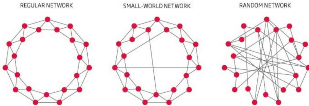
FIGURE 2.22 – Modèle de réseau de Watts & Strogatz. Transition entre un réseau régulier à gauche, vers un réseau aléatoire à droite. Le réseau intermédiaire au centre est obtenu en réorganisant au hasard une fraction p des connections du réseau régulier. Le réseau régulier est fortement interconnecté localement (clustering élevée) mais un diamètre élevé. Le réseau aléatoire a un clustering faible mais un petit diamètre. Le réseau intermédiaire possède à la fois un petit diamètre et un clustering élevé : on dit qu'il a une caractéristique petit monde [WATTS et STROGATZ, 1998]
